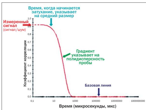
Рис. 10. Кривая зависимости коэффициента корреляции показывает, насколько быстро происходит потеря корреляции в получаемой картине флуктуации рассеянного света. Для более мелких частиц потеря корреляции происходит быстрее, чем для крупных
